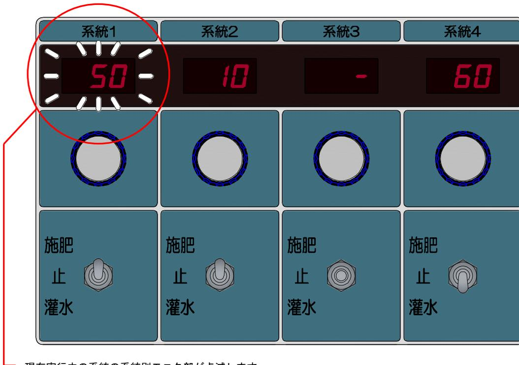
現在実行中のシステムの系統別モニタ部が点滅します。
