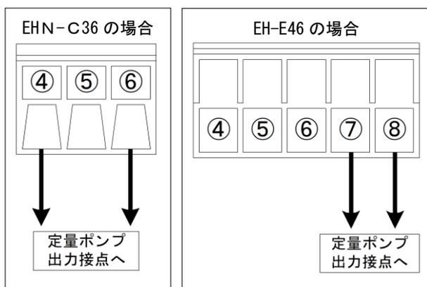
定量ポンプのコントロールユニット内にある、端子接続ソケット<sup>①</sup>よりパルス信号用に2芯を取り出し、本機端子台の定量ポンプ出力接点へ接続します。
