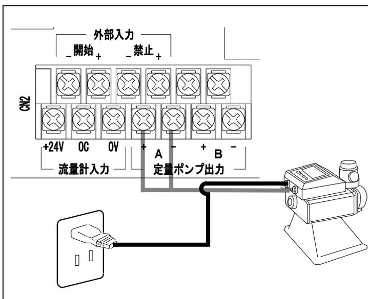
定量ポンプの電源を、コンセントより供給する場合の接続です。
