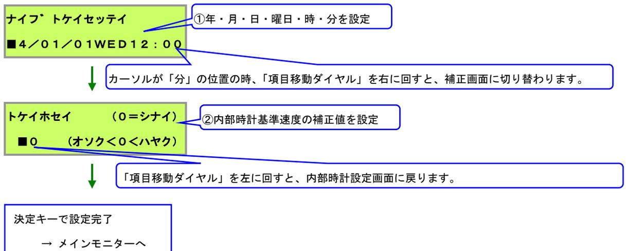
「24時間タイマー」と「週間タイマー」とは無関係の内部タイマー(メイン基板内部時計)で、「灌水履歴」、「警報履歴」、「灌水率0:00リセット」と連動する、内部時計機能となります。
