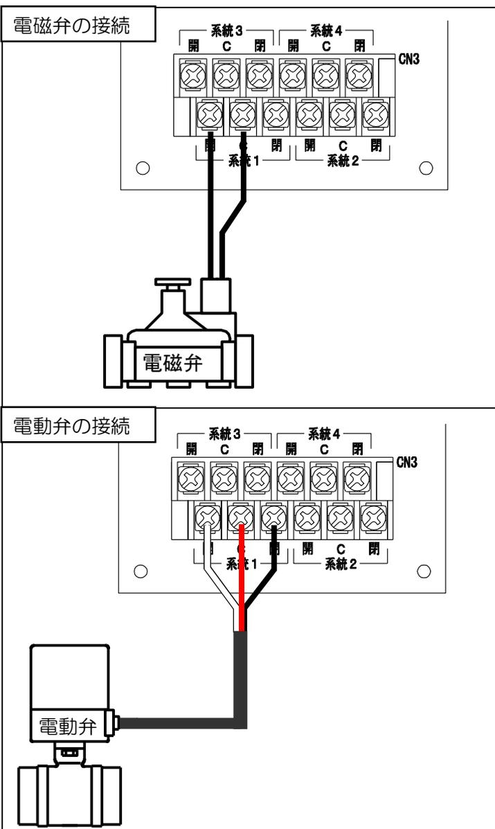
電磁弁を接続する際、開とCに電磁弁を接続してください。
