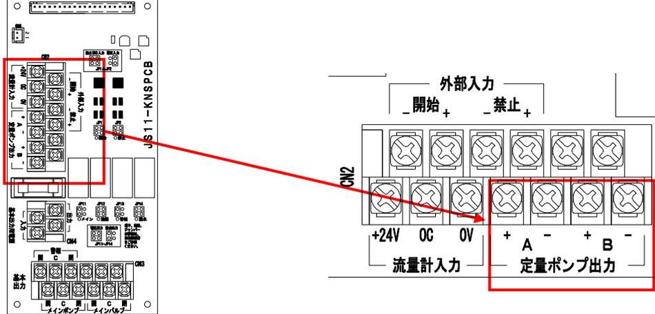
図① 定量ポンプ接続（端子台より電源供給）
