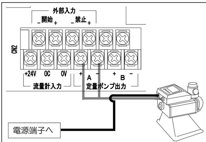
定量ポンプの電源を、端子台より供給する場合の接続です。
