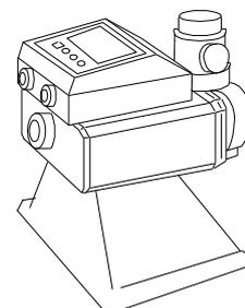
施肥が終了したら、スタート/ストップキーを押して定量ポンプの動作を停止させてください。
